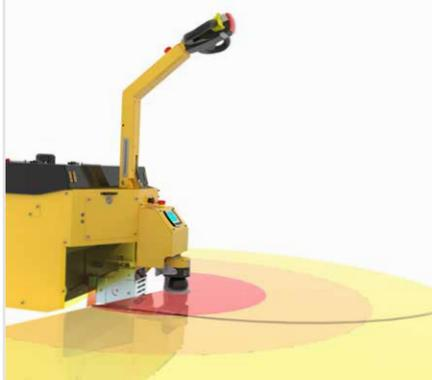
Le fonctionnement autonome permet de ne pas avoir recours à des opérateurs pour déplacer les charges.
