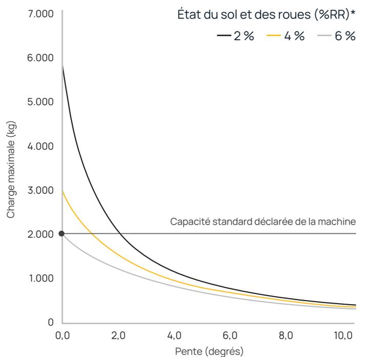
\* D'autres variables comme la nature/qualité du terrain et le type/condition/qualité des roues de charge peuvent affecter la capacité de déplacement de la charge.
